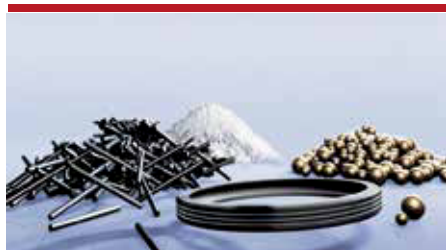
Moderne PTFE-Compounds lassen sich gut an die jeweilige Anforderung anpassen – hier die Kombination verschiedener Füllstoffe für einen Radialwellendichtring (Bild: Dyneon GmbH)
