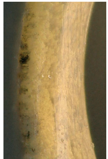
Bild 5. Durch den Zusatz der entsprechenden Additive kann die Schaumbildung fast vollständig verhindert werden. Die Carbonisierung fand in diesem Fall lediglich an der Oberfläche statt (© Fietz Polychromos)
