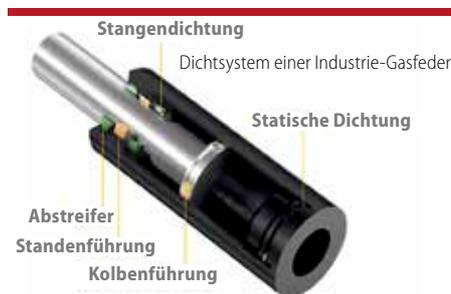
Leichtgängigkeit und hohe Gasdichtheit charakterisieren die aus FiPur gefertigten Dichtelemente (Bild: Fietz Automotive GmbH)
