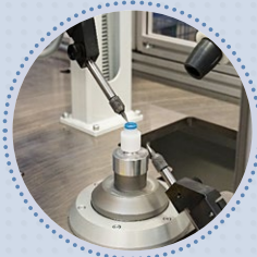
Endbearbeitung Abstechen der Dichtkanten (SPC-Überwachung)
